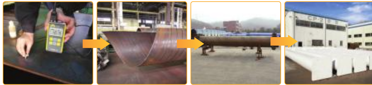
▲ 철강 코일 자체 검수 ▲ 강관 조강 및 제단 ▲ 강관 단부 PLATE 설치 ▲ 샌딩 및 도색
