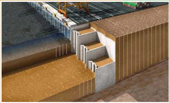
VE제안 - Slurry Wall 안벽 시공계획
